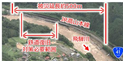
＜護岸洗掘による国道41号の被災状況＞
