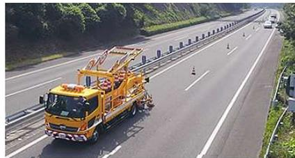
＜規制機材の自動設置状況＞
