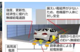
走行中給電施設
