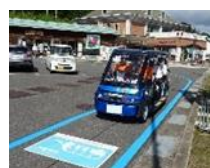
路上駐車対策 (走行位置の明示)
