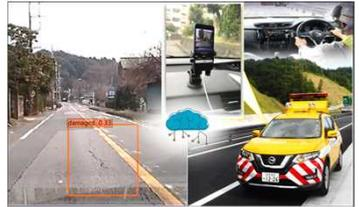
パトロール車両に搭載したカメラからのリアルタイム映像をAIにより処理し、舗装の損傷を自動検知
