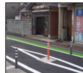
進入抑制対策および速度抑制対策の例
