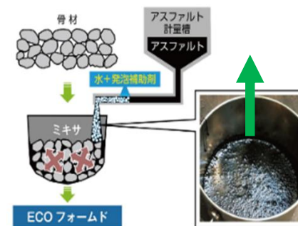
アスファルトの中温化技術
