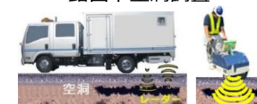
路面下空洞調査
