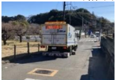
(空洞探査車による調査)
